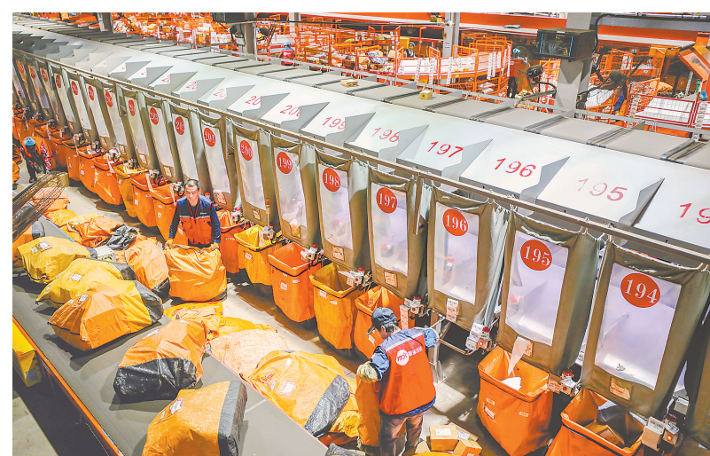
圆通仓配分拣中心的自动化交叉带分拣系统在高效运转。
