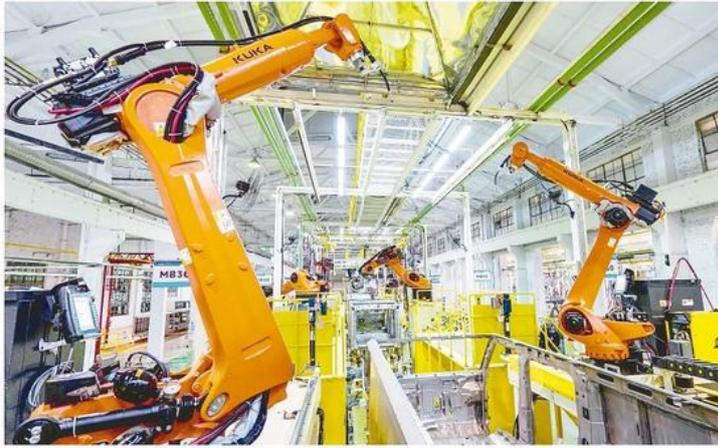
河北红星汽车制造有限公司拼装生产线，机械臂上下翻飞进行车身拼装。本报记者 魏海强 通讯员 苏瑞岩
